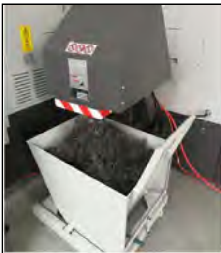
图 8 下脚料、金属屑收集暂存设施
