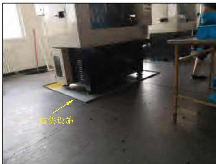
图 9 废切削液、磨削液收集设施
